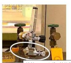
溶接シールドガス節約器
