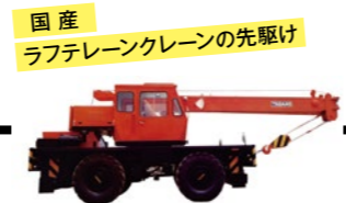
国産 ラフテレーンクレーンの先駆け 多田野鉄工所(現・タダノ) TR-150 ラフテレーンクレーン(1970) 運転席で道路走行とクレーン作業の二つの操作が可能。四輪駆動で悪路にも強くコンパクトでもあるため、狭い不整地の現場にも対応。
