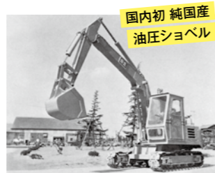
国内初 純国産 油圧ショベル 日立建機 UH03 油圧ショベル(1965) バケット容量0.3m 3 、重量8.3t。ユーザから高い評価を得、世界各地で活躍する「日立 UH 油圧ショベル」の完成させ、警察予備隊へ納入。
