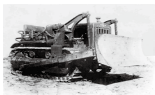
小松製作所(コマツ) D50A ブルドーザ(1947) 55馬力、重量8t。戦時中に試作したトロー車をベースに開発。故障が多く、その後多くの改良が施される。
