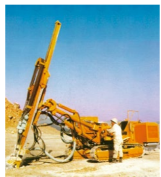
古河鉱業(現・古河ロックドリル) HCR200 クローラドリル(1977) 油圧式クローラドリルの国産第1号。1983(昭和58)年ごろから本格的な全油圧式ドリルの時代へ突入。
