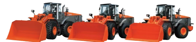
日立建機 ZW シリーズホイールローダ(2006) TCM と共同開発。走行性能の大幅向上をはじめ、操作性・作業性に優れたオフロード法に対応した次世代のモデルとなりました。
