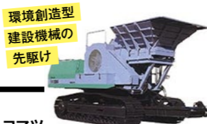
環境創造型 建設機械の 先駆け コマツ BR60 自走式破砕機(1992) コンクリート塊などのガラを、その場で細かく破砕、路盤材や建築物の基礎材に再利用にと開発。
