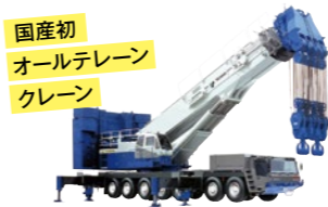
国産初 オールテレーン クレーン タダノ AR-5500 オールテレーンクレーン(1998) 国内最大 550t 吊りオールテレーンクレーン。
