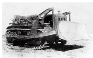
小松製作所(コマツ) D50A ブルドーザ(1947) 55馬力、重量8t。戦時中に試作したトロ車をベースに開発。故障が多く、その後多くの改良が施される。
