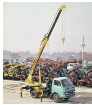
国産 ラフテレーンクレーンの先駆け 多田野鉄工所(現・タダノ) TR-150 ラフテレーンクレーン(1970) 運転席で道路走行とクレーン作業の二つの操作が可能。四輪駆動で悪路にも強くコンパクトでもあるため、狭い不整地の現場にも対応。
