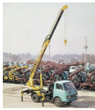
多田野鉄工所(現・タダノ) TR-150 ラフテレーンクレーン(1970) 運転席で道路走行とクレーン作業の二つの操作が可能。四輪駆動で悪路にも強くコンパクトでもあるため、狭い不整地の現場にも対応。
