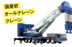
タダノ AR-5500 オールテレーンクレーン(1998) 国内最大 550t 吊りオールテレーンクレーン。
