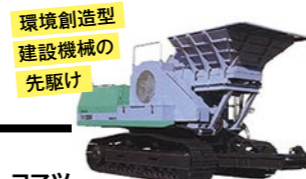
コマツ BR60 自走式破砕機(1992) コンクリート塊などのガラクを、その場で細かく破砕、路盤材や建築物の基礎材に再利用にと開発。
