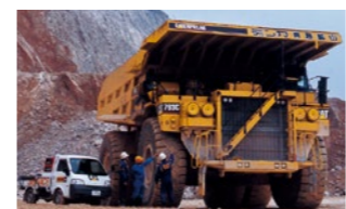
新キャタピラー三菱(現・キャタピラー) CAT793C ダンプトラック(2002) 積載重量218t、重量147.4t、定格出力1615kWの国内最大の超大型ダンプトラック。石灰石鉱山で稼働。
