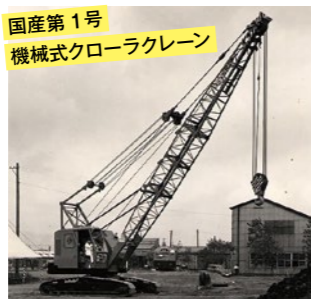
国産第1号 機械式クローラークレーン 石川島コーリング(現・加藤製作所) 330 スプローラークローラークレーン(1952) 石川島重工業が米国・コーリング社と技術提携、設立した石川島コーリングが製造した機械式クレーン。
