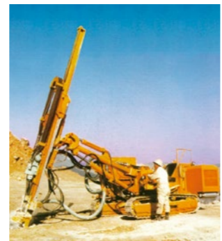
古河鉱業(現・古河ロックドリル) HCR200 クローラードリル(1977) 油圧式クローラードリルの国産第1号。1983(昭和58)年ごろから本格的な全油圧式ドリルの時代へ突入。
