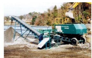
オカダアイオン PCP-S001 自走式クラッシャー(1987) 解体現場用自走式のクラッシャーとしては国内初。
