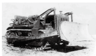
小松製作所(コマツ) D50A ブルドーザ(1947) 55馬力、重量8t。戦時中に試作したトロー車をベースに開発。故障が多く、その後多くの改良が施される。
