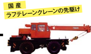
国産 ラフテレーンクレーンの先駆け 多田野鉄工所(現・タダノ) TR-150 ラフテレーンクレーン(1970) 運転席で道路走行とクレーン作業の二つの操作が可能。四輪駆動で悪路にも強くコンパクトでもあるため、狭い不整地の現場にも対応。
