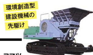
環境創造型 建設機械の 先駆け コマツ BR60 自走式破砕機(1992) コンクリート塊などのガラクタを、その場で細かく破砕、路盤材や建築物の基礎材に再利用にと開発。
