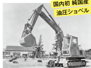
国内初 純国産 油圧ショベル 日立建機 UH03 油圧ショベル(1965) バケット容量0.3m 3 、重量8.3t。ユーザから高い評価を得、世界各地で活躍する「日立 UH 油圧ショベル」の土台となる。
