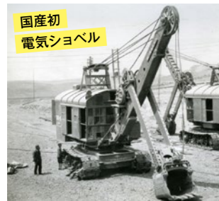
国産初 電気ショベル 神戸製鋼所(現・コベルコ建機) 50K 電気ショベル(1930)
