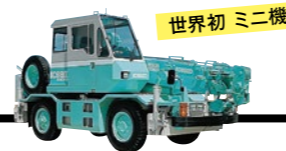
世界初 ミニ機 神戸製鋼所(現・コベルコ建機) RK70M/RK70 ミニラフテレーンクレーン(1989)
