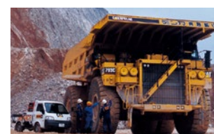
新キャタピラー三菱（現・キャタピラー） CAT793C ダンプトラック（2002） 積載重量 218t、重量 147.4t、定格出力 1615kW の国内最大の超大型ダンプトラック。石灰石鉱山で稼働。
