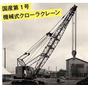
国産第 1 号 機械式クローラクレーン 石川島コーリング（現・加藤製作所） 330 スブローラクローラクレーン（1952） 石川島重工業が米国・コーリング社と技術提携、設立した石川島コーリングが製造した機械式クレーン。
