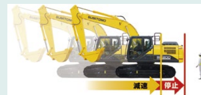
危険時に機械が自動で減速・停止(旋回時の制動イメージ)
