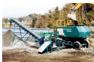
オカダアイオン PCP-S001 自走式クラッシャー（1987） 解体現場用自走式のクラッシャーとしては国内初。
