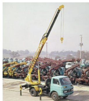
愛知車輛（現・アイコーボレーション） AC-D4E 穴掘建柱車（1966） 建柱車と穴掘車の二つの機能を一体化。建柱車 AC-D4 の改良版。
