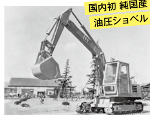
国内初 純国産 油圧ショベル 日立建機 UH03 油圧ショベル（1965） バケット容量 0.3m 3 、重量 8.3t。ユーザから高い評価を得、世界各地で活躍する「日立 UH 油圧ショベル」の土台となる。
