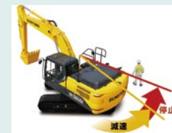
危険時に機械が自動で減速・停止(後進・走行時の制動イメージ)
