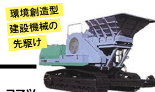
環境創造型 建設機械の 先駆け コマツ BR60 自走式破碎機（1992） コンクリート塊などのガラを、その場で細かく破碎、路盤材や建築物の基礎材に再利用にと開発。
