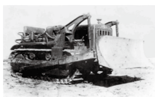
小松製作所（コマツ） D50A ブルドーザ（1947） 55馬力、重量 8t。戦時中に試作したトラックをベースに開発。故障が多く、その後多くの改良が施される。
