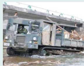
水辺を乗り越え廃材を運ぶ資材運搬車(陸上自衛隊仕様)
