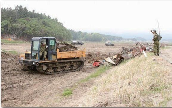
石巻にて陸地に流れ着いた廃材を運ぶ不整地運搬車
