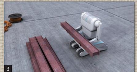
2 3 ロボットが資材置き場までのルートを計算して資材を降ろす。
