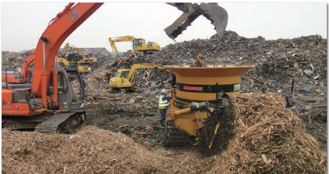
気仙沼にて、油圧ショベルと協働し木材がれきを粉砕する自走式木材破砕機
