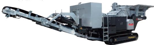
自走式クラッシャー(インパクトクラッシャー) 中山鉄工所NE2001
